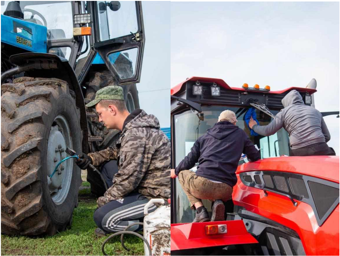
Рис.7. Отряд «Агроинженер». Бойцы отряда производят техническое обслуживание техники и оборудования перед полевыми работами.
